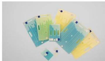
La temperatura de congelación debe ser al menos 5°C inferior a la temperatura de fusión del líquido eutéctico. La duración de acumulación por congelación puede variar entre 6 y 24 horas dependiendo del equipo frigorífico utilizado
